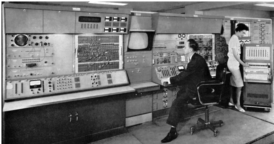
Fig. 6.8. EAI HYDAC-2000 system (see [N. N. 1964/1])
