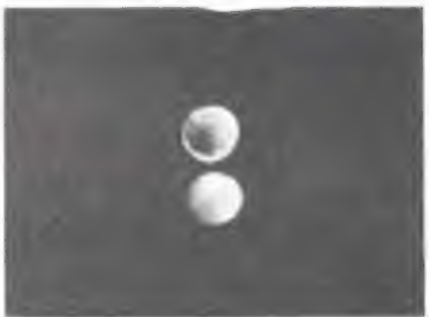
Наблюдение распределения скорости движущейся жидкости в сечении сосуда. В нижней трубке вода стоит, в верхней — течет.
