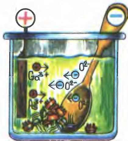
Схема наращивания слоев кремния из жидкой фазы (Si + Sn)
